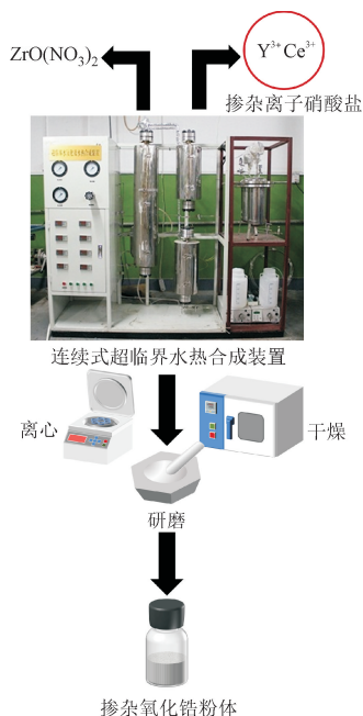
图1 超临界水热合成掺杂纳米氧化锆实验装置及流程
